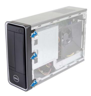
Gire y tire del panel frontal para separarlo del equipo y soltar las abrazaderas del bisel de las ranuras del panel frontal.
