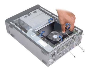
Ensamblaje del ventilador y el disipador de calor del procesador
